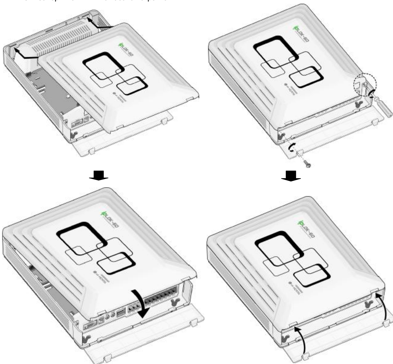
Рис 3.2.3.2 Установка лицевой панели
